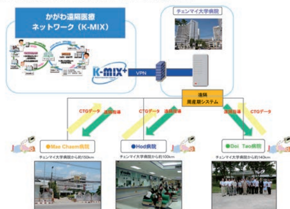
(図10) JICA 草の根事業(周産期システム)概要 チェンマイ大学と専門医のいないマチャム病院(チェンマイから150km)、ホッド病院(100km)、そしてドイタオ病院(140km)の3病院をモバイルネットワークで接続した。
