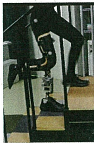
図2 開発した膝継手による階段昇段実験
