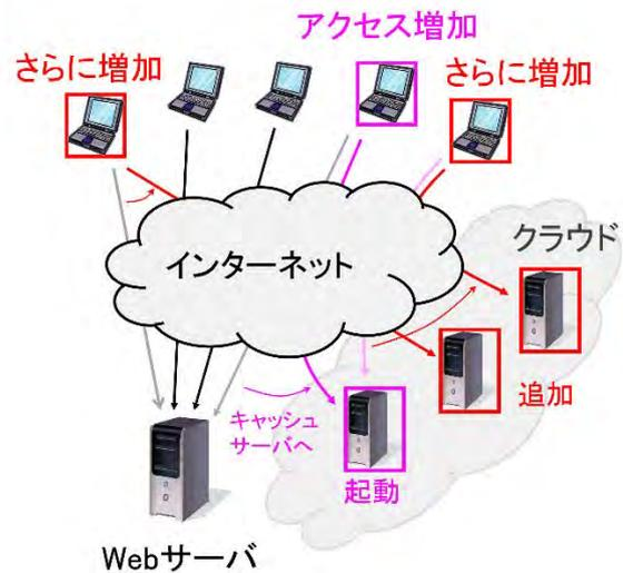
図 1 分散 Web システムにおける負荷分散の概要
