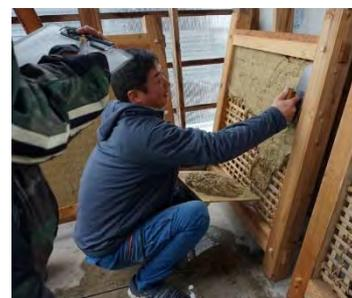
図2 施工性試験
