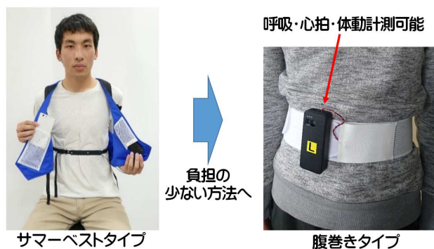
図4、改良しより負担の少ない呼吸センサ
