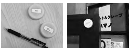
ビーコン(発信器)外観(左)と取付状況(右)
