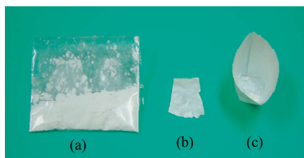
(a): 層状チタン酸粉末原料、(b): ナノ粒子から作製した層状チタン酸シート、(c): シートから作った折紙コップ
