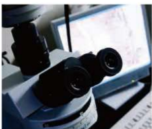
日本初の生体観察ビデオシステム。血液の流れなどを生きのまま見ることができる。
