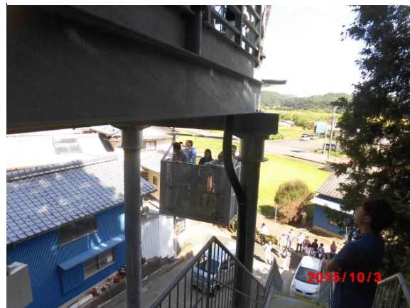
写真 15 5 人が乗ったゴンドラを吊上げている様子
