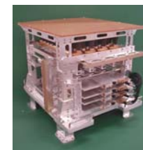
NICTによる64素子電子走査ビームアンテナ(APAA)試作モデル (WINDS搭載品は128素子)
