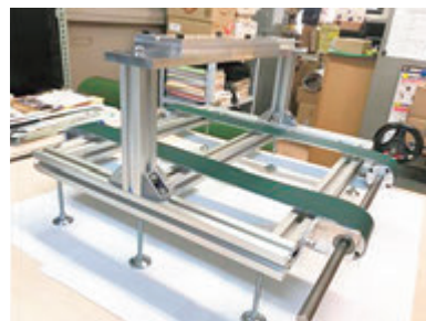
試作した種まき機械の補強した構造部分
