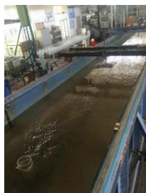
インド工科大学グワハチ校の大規模な水槽実験装置
