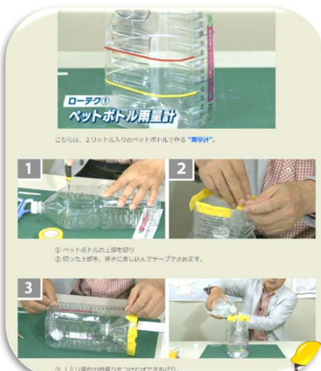
ペットボトル簡易雨量計（アメミルペット）の作り方
