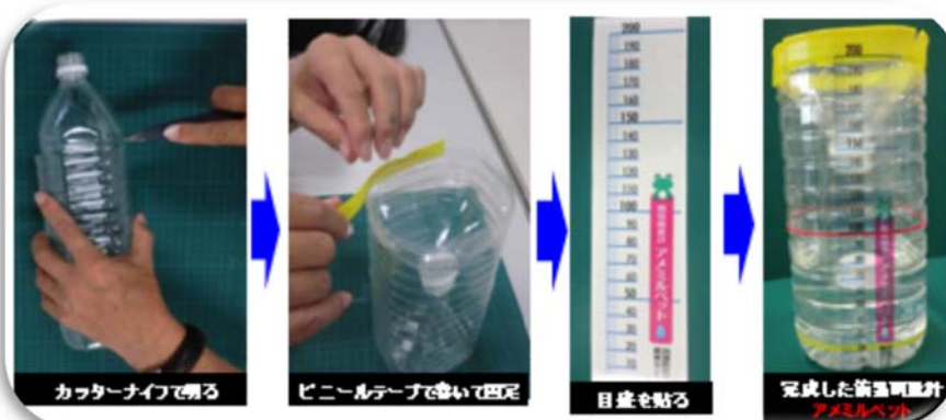
ペットボトルを活用して簡易雨量計をつくり雨量を計る方法
