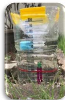
簡易雨量計の設置
