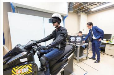
Virtual Realityの技術を駆使した、二輪車、四輪車の運転シミュレータを開発し、交通事故の発生メカニズムの分析や交通事故を予防するシステムの開発を行っています。
