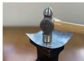
部品は材料を工具で加工して作られます。ここでは、板材をハンマーで叩いて形を変えるか加工の体験してもらいます。新幹線の先頭などはこの方法で作られています。また、新機能性材料として、スポンジ状の金属を紹介します。
