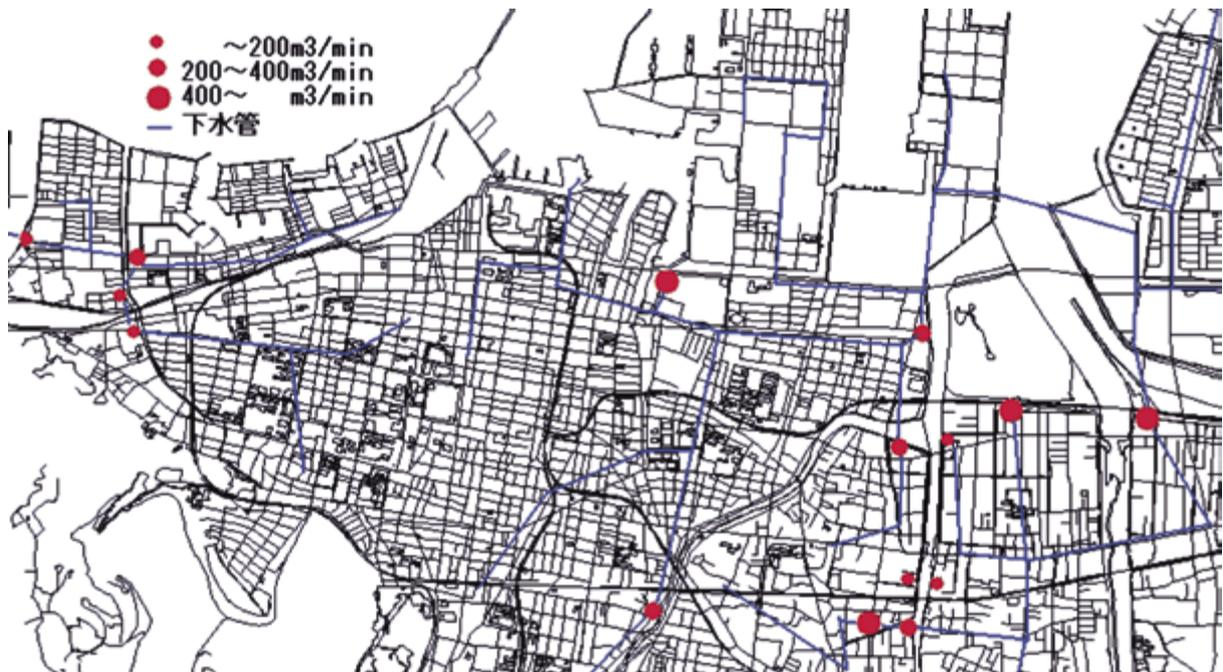
図5.17 高松市内北部のポンプ配置図
