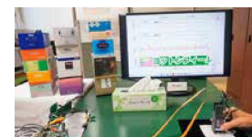
14種類のティッシュペーパーを95%以上の正確さで識別するセンシングシステム（計測と同時に画面に「銘柄」を表示）
