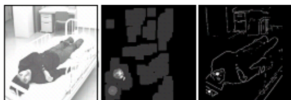
カメラからの映像 顔候補領域 顔位置認識結果 図1 自由姿勢における顔認識研究の例
