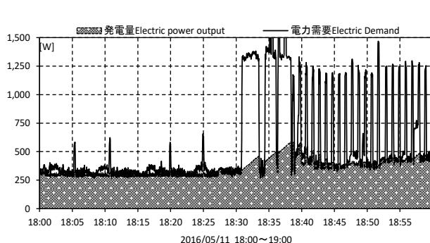
図 1 電気使用量と FCCGS 発電量の関係
