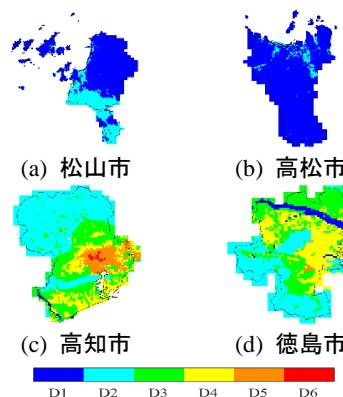
図 6 最大クラスの損傷度マップ ( $I_w=0.7$ )
