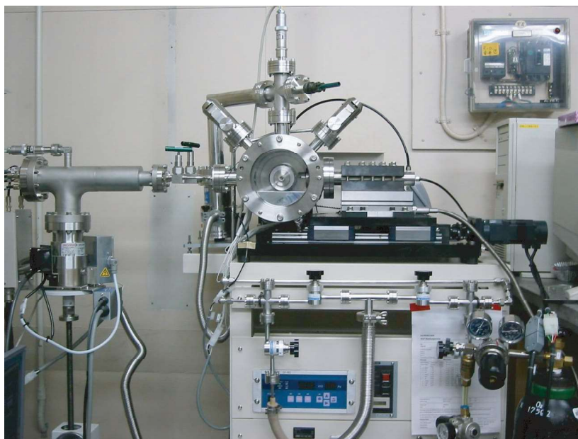
MQL加工油剤の作用メカニズム解明に用いる 雰囲気制御切削試験器
