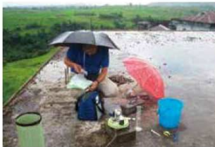
インド訪問時には、現地に設置した雨量計のメンテナンスも行う。
