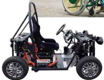
筋負担を軽減しながら心理的ストレスをも軽減し、楽しみながら移動できる、レバー式車椅子。
