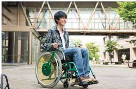
筋負担を軽減しながら心理的ストレスをも軽減し、楽しみながら移動できる、レバー式車椅子。
