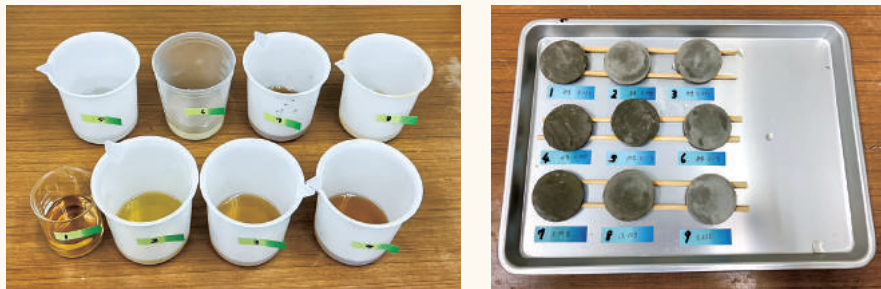
使用したアミノ酸とそれらを塗布したコンクリート試験体
