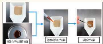
燃え殻試料の調製工程
