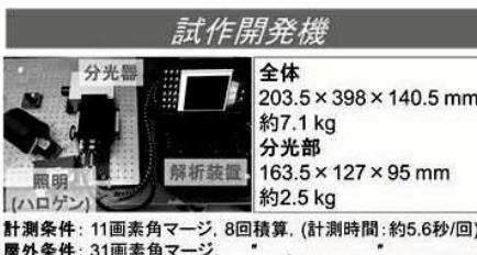
計測条件: 11画素角マージ, 8回積算, (計測時間: 約5.6秒/回)
