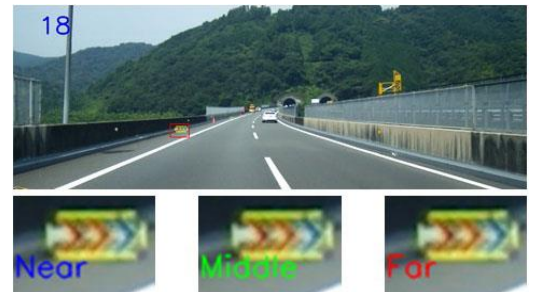
図1 仮想平面を設定した道路規制機材検出結果の一例
