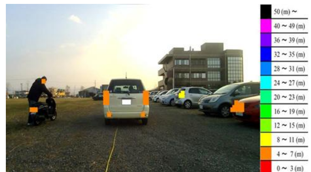
図3 前方車両との距離推定結果の一例
