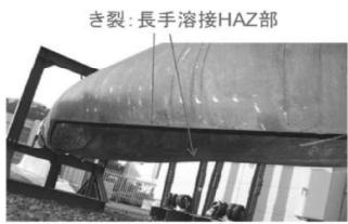
実機配管試験体の外観写真（破断後）
