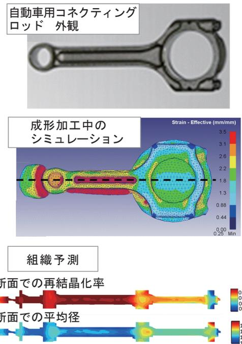
図 2 Ti 合金製コネクティングロッド成形過程シミュレーションと組織予測
