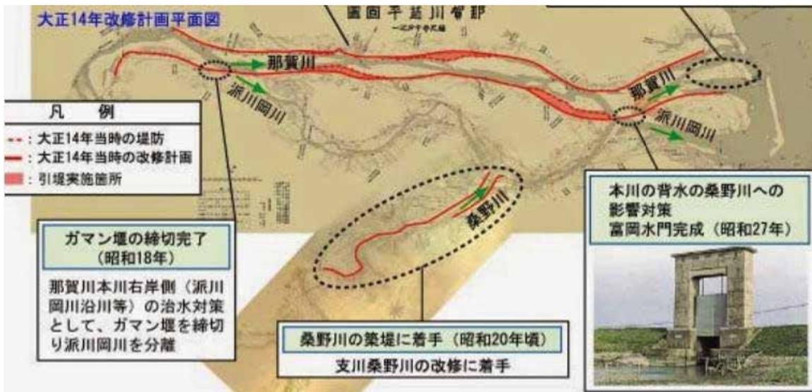
図1 大正14年の那賀川改修計画平面図の上にガマン堰を締め切った場所を示した図
