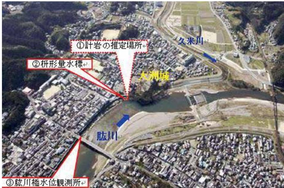
写真3 大洲地点の水位観測位置の変遷 (大洲河川国道事務所提供写真に加筆)
