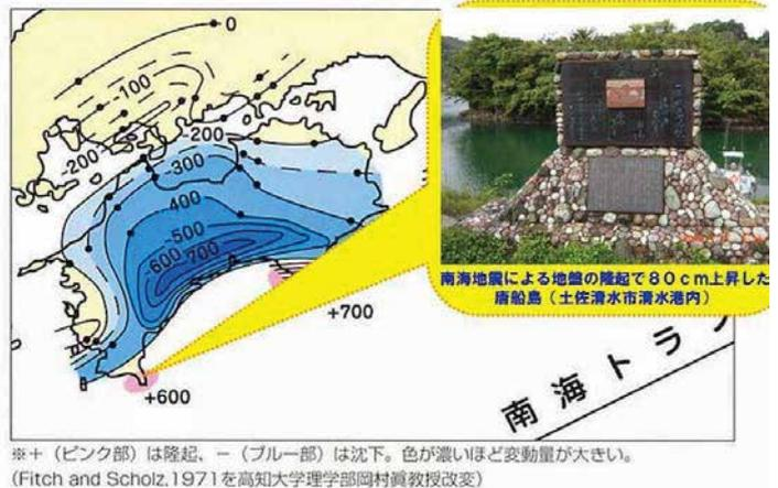
図1 昭和南海地震による地殻上下変動図と史蹟碑
