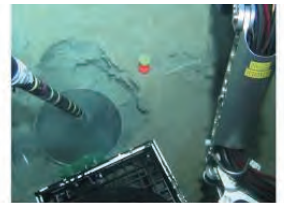
堆積物除去して地震計パッケージの埋設孔を作成
