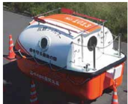
写真 5 救難シェルター
