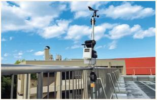
(写真3) 香川中央高校に設置した自動気象観測装置
