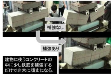
コンクリート部材の耐荷力試験
