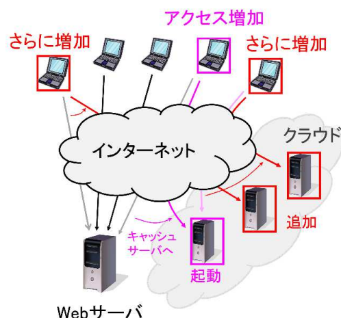
図2 分散 Web システムにおける負荷分散の概要
