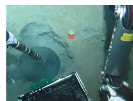
地震計パッケージと圧力センサーパッケージ 堆積物除去して地震計パッケージの埋設孔を作成
