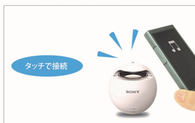
NFCと無線通信を利用した直感的な機器間接続技術の発明 (NFC: Near Field Communication)
