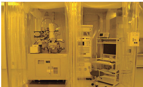
電子線描画装置 (エリオニクス社製 ELS-7500EX)
