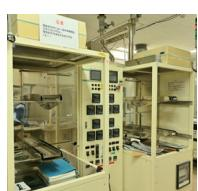
**酸化 / 拡散炉** ※
