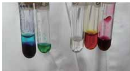
合成したカラフル磁性イオン液体
