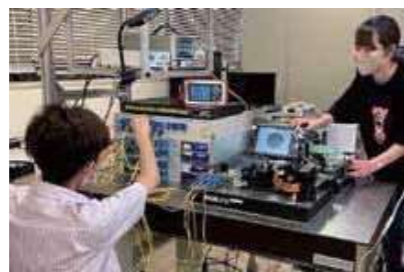
PHUJINプロジェクトで開発する空間クロスコネクタ試作機
