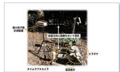
筑波実験植物園におけるキノコ孢子の野外計測
