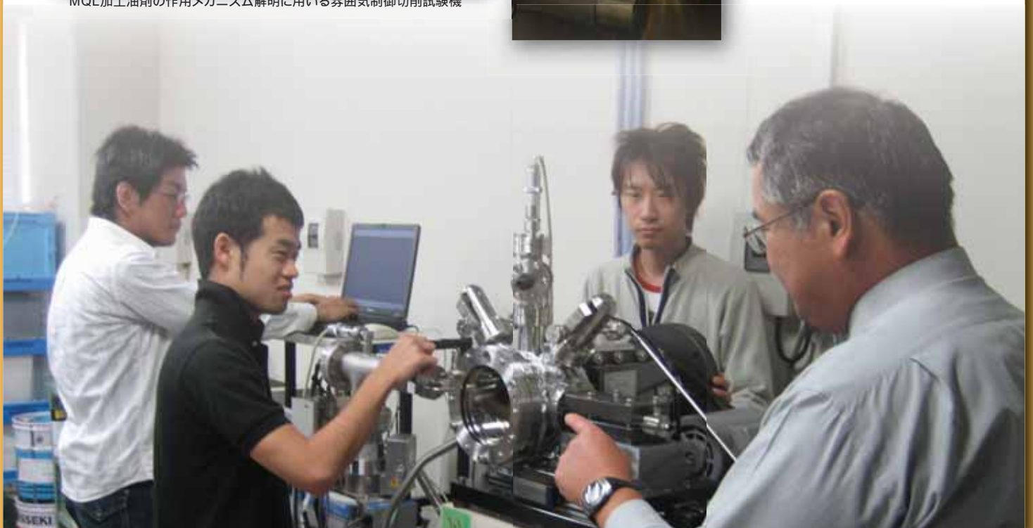
MQL加工油剤の作用メカニズム解明に用いる雰囲気制御切削試験機
