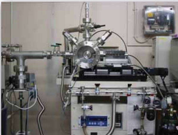
MQL加工油剤の作用メカニズム解明に用いる雰囲気制御切削試験機
