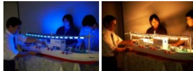
従来のメタルハライド灯に代わりLEDを利用するイカ釣り船の模型。光害対策と省エネルギーの実現へ大きな注目を集めています。
