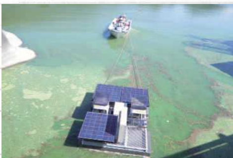
水質浄化装置の曳航状況
