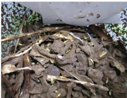
シロアリへの抵抗性の確認実験
