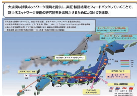
（図10）超高速のネットワーク JGN-X（新世代通信網テストベッド） JGN-X は、国立研究開発法人情報通信研究機構（略称：NICT）が新世代の通信網の研究開発用に運用している、世界でも最も進んだテスト用ネットワーク（テストベッド）である。ICT の最先端の技術開発はもちろん、遠隔医療での応用など幅広い領域での利活用が進められている。
