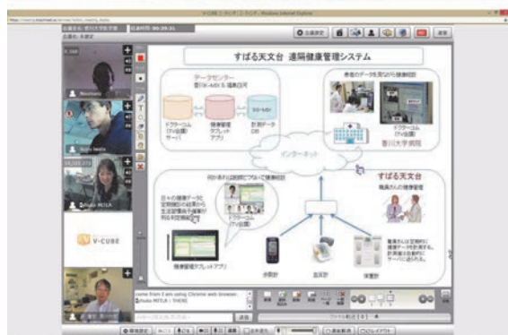
（図9）ハワイのすばる天文台との遠隔健康管理システムすばる天文台の過酷な環境下で勤務する研究者の健康管理に役立てるため、本プロジェクトで構築したネットワーク基盤を用いて、香川大学との間で遠隔健康管理システムをテスト運用している。
