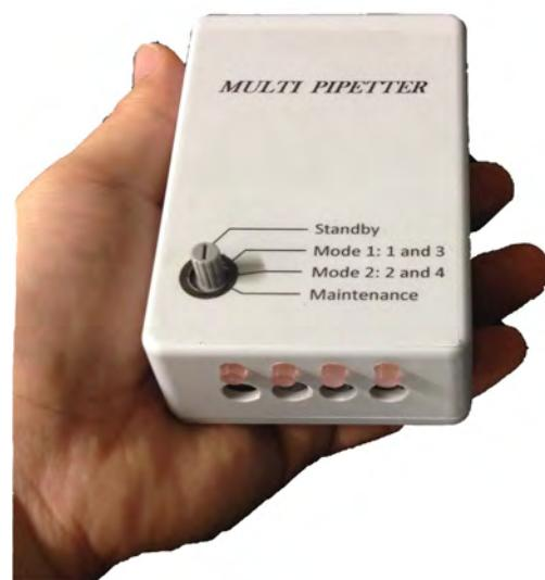
CNT アクチュエータ・ピペットを用いて試作したプログラム可能なマルチピペット
