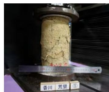
図 1 一軸圧縮試験
