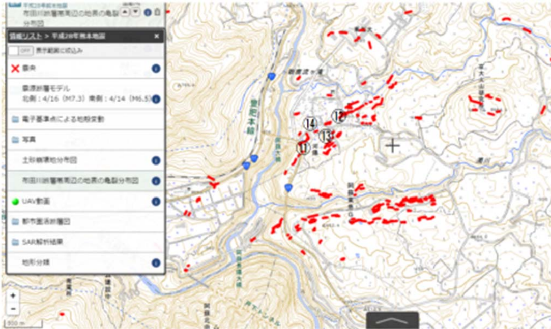
図 3.14 国土地理院による布田川断層帯周辺の地表亀裂分布図（南阿蘇村付近）に加筆
