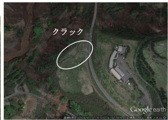
図 5-8 地点③の段丘崖の崩壊（左）と滑落崖付近のクラック（右）
