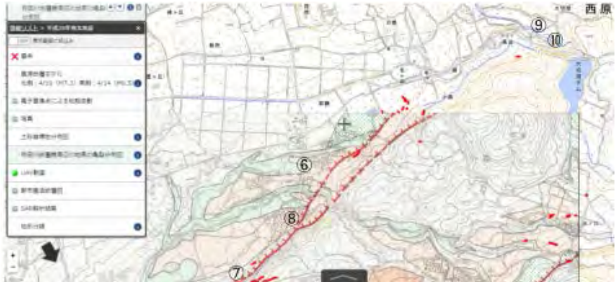
図 3.9 国土地理院による布田川断層帯周辺の地表亀裂分布図 (西原村付近) に加筆
