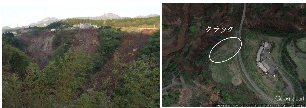
図 5-8 地点③の段丘崖の崩壊（左）と滑落崖付近のクラック（右）
