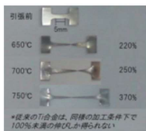
Fig.2 Ti 合金の超微細粒組織形成と低温・高速超塑性
