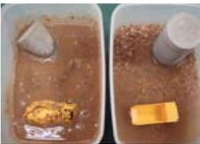
地震の際には地盤が揺らされて液状化現象が発生します。この液状化現象は、土の粒の大きさによって発生の程度が異なります。どの大きさの土が最も液状化しやすいかどうかを実験で確かめます。あなたが住んでいる地盤は大丈夫でしょうか。
