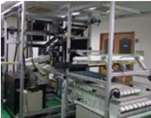
TVカメラを使って、仕事をするロボットの目を作ります。昨年は、床の上に乱雑に置かれた洗濯物をロボットで掴んで、織り込まれたマークを読み取って整列するロボットを開発しました。動いている様子を、画像で見せます。
