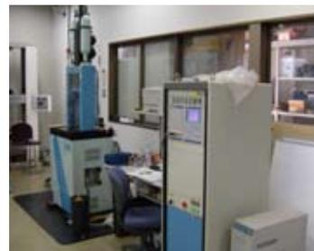
自動車には、事故時の衝撃から乗員を保護する衝撃吸収特性に優れた材料が使用されています。私たちの研究室では、衝撃吸収特性に優れた自動車用材料の開発に取り組んでいます。衝撃吸収特性の評価に用いられる高速変形試験の実演も行いますので、お気軽にお越しください。
