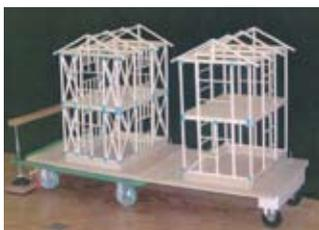
建物は何故壊れるのか? 手回し携帯振動台を用いて建物の揺れ方を確認してください。また、在来軸組み住宅の縮小模型実験により、倒壊の様子を観察し、地震に弱い建物の特徴を調べてください。耐震化がいかに重要か、これらの実演により、耐震補強効果が実感できます。お土産にペーパークラフト教材を持って帰ろう!
