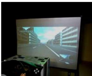
自動車の運転は前後左右への注意と安全操作が不可欠です。ここでは、運転環境を模擬したコクピット型シミュレータを用いてドライバの運転操作の特性や特徴を調べています。
