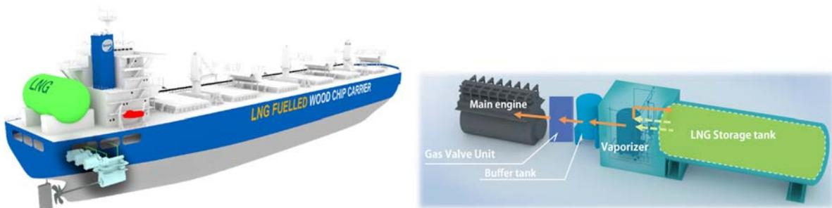
図 1 : LNG 燃料木材チップ運搬船 (左図)、LNG 燃料供給システム (右図)
