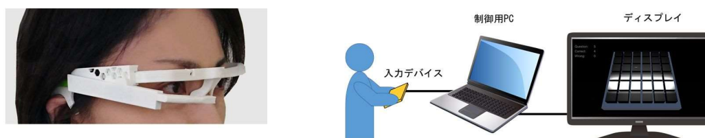
図2 視線解析デバイスとオフライン目視検査訓練システム
