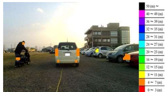
図3 前方車両との距離推定結果の一例
