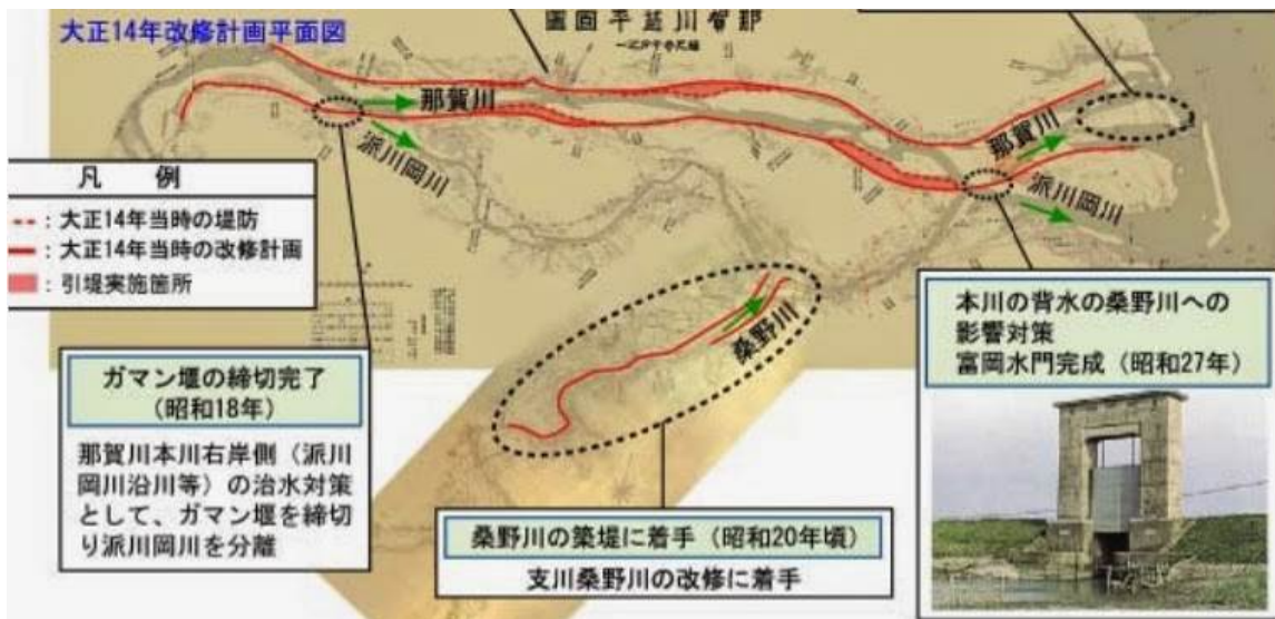
図1 大正14年の那賀川改修計画平面図の上にガマン堰を締め切った場所を示した図
